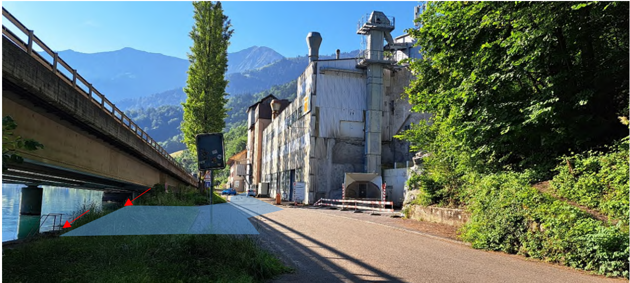
Abb. 15: Auf der Parzelle 615 besteht lokal eine mittlere bis geringe Gefährdung durch Seehochstand. Sie beschränkt sich hauptsächlich auf den nördlichen Bereich der Parzelle, wo die Zufahrt und der asphaltierte Platz die geringste Höhe über Meer aufweisen (blaue Fläche). Ungefähr bei den roten Pfeilen tritt der See über die Ufer und flutet das Gelände.
